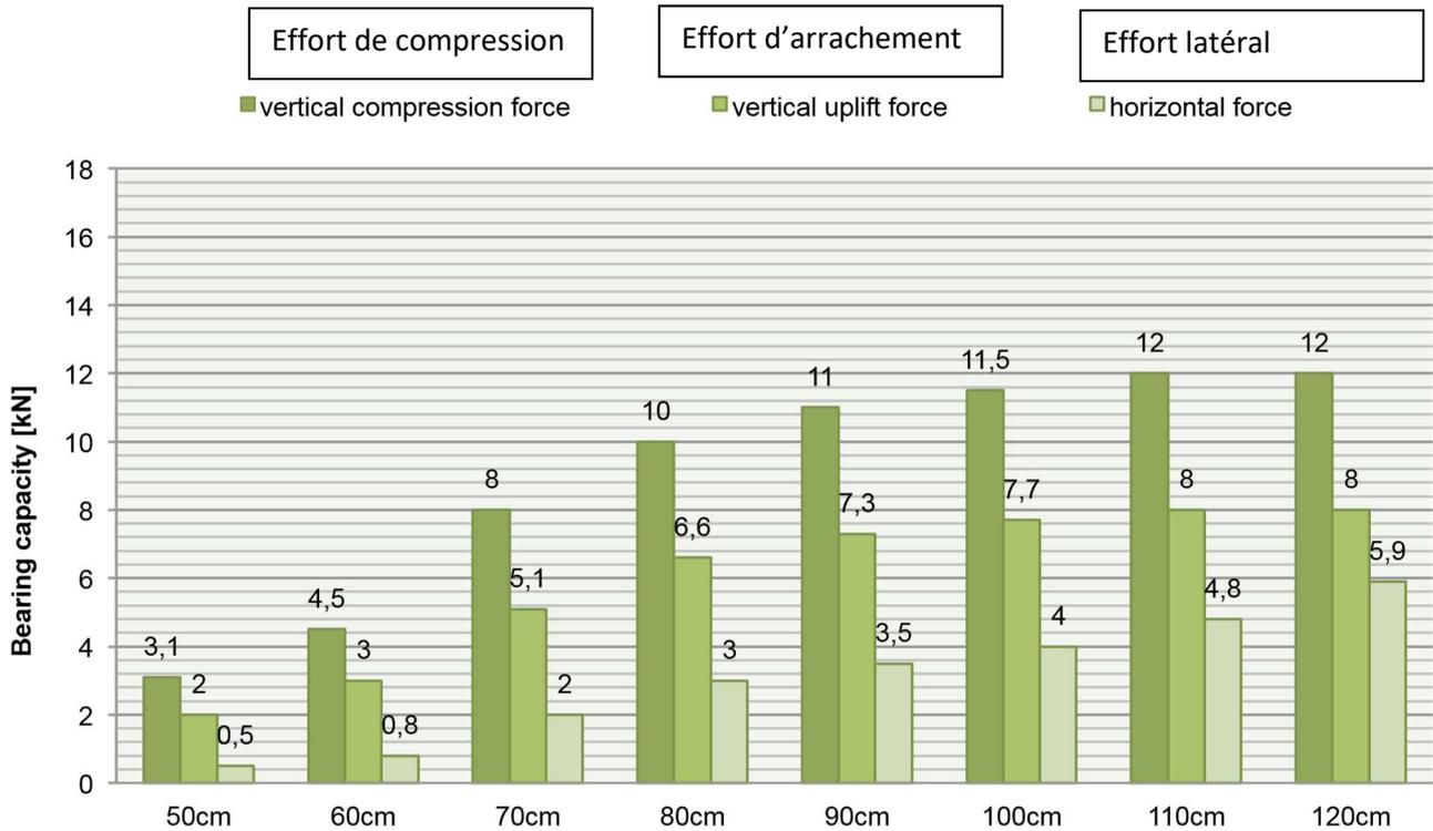
Exemple : vis de 60 cm peut reprendre 450 kg en compression, 300 kg en arrachement et 80 en latéral
